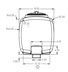
TANK WITH SUMP STANDARD LOCATION IS IN SUMP.
